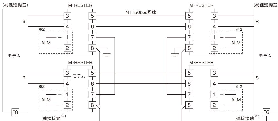
※1、必ず連接地を施して下さい。被保護機器に接地端子がない場合は、本器のみ接地して下さい。
