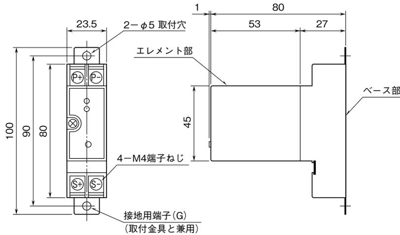
取付寸法図 (単位: mm)
