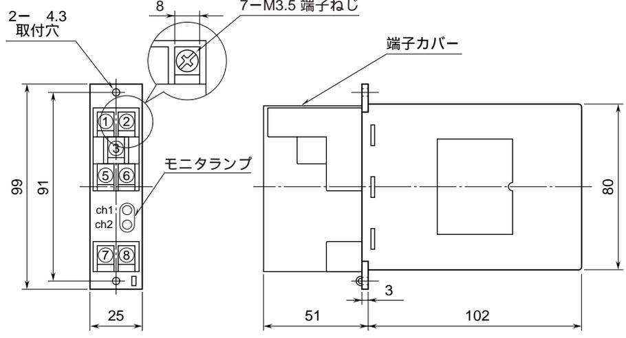
取付寸法図 (単位: mm)
