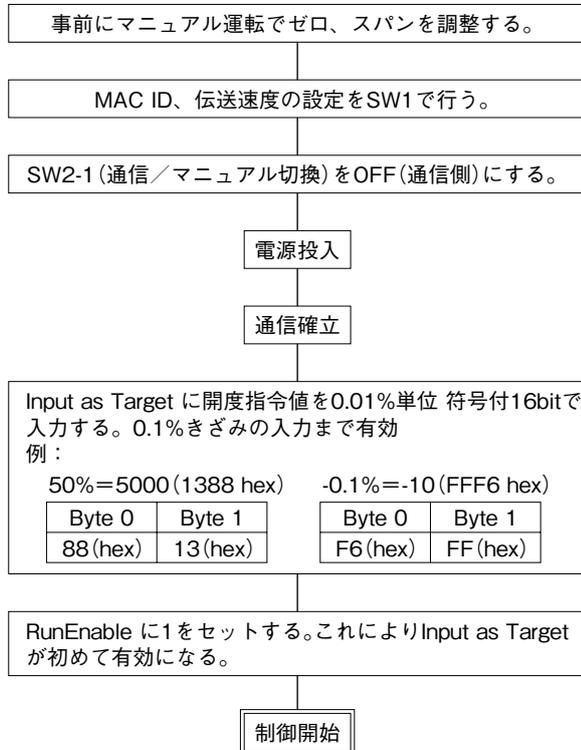
ネットワークが確立された後は、RunEnable をセットして Input as Target に入力するだけで、簡易に使用可能です。
