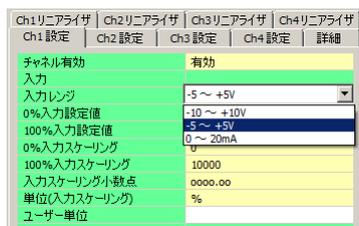
エディットボックス：たとえば [0%入力スケーリング] の場合、設定値をクリックするとエディットボックスが表示され、数値を入力し、**Enter** キーを押します(下図参照)。
