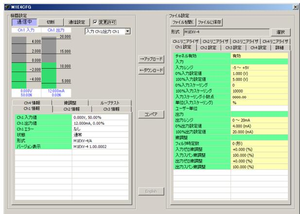
機器の入出力のレベルをバーグラフで表示し、その下の [Ch1 情報] [Ch2 情報] [Ch3 情報] [Ch4 情報] [微調整] [ループテスト] タブから各種操作ができます。バーグラフに表示する入出力チャンネルは、プルダウンリストより選択します。
