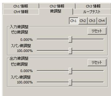
入力微調整は、機器の表示画面に表示される入力値または、M1E4CFG の [機器設定] 枠内上部に表示される入力値を確認しながら調整します。入力信号が 0%の状態の入力のゼロ微調整を、100%の状態の入力のスパン微調整をします。
