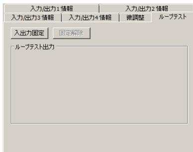
[入出力固定] ボタンをクリックすると、現在の入力に応じた出力信号で固定されます。下図のように出力信号を操作できる状態になります。この状態では入力に変化しても出力は変わりません。
