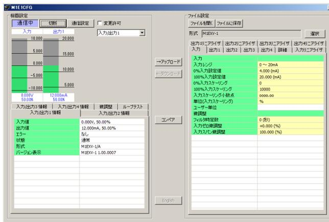
機器の入出力のレベルをバーグラフで表示し、その下の [入力/出力 1 情報] [入力/出力 2 情報] [入力/出力 3 情報] [入力/出力 4 情報] [微調整] [ループテスト] タブから各種操作ができます。バーグラフに表示する入出力値は、プルダウンリストより選択します。
