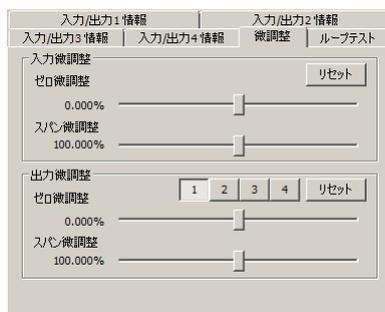
入力微調整は、機器の表示画面に表示される入力値または、M1E1CFGの[機器設定]枠内上部に表示される入力値を確認しながら調整します。入力信号が0%の状態での入力のゼロ微調整を、100%の状態での入力のスパン微調整をします。
