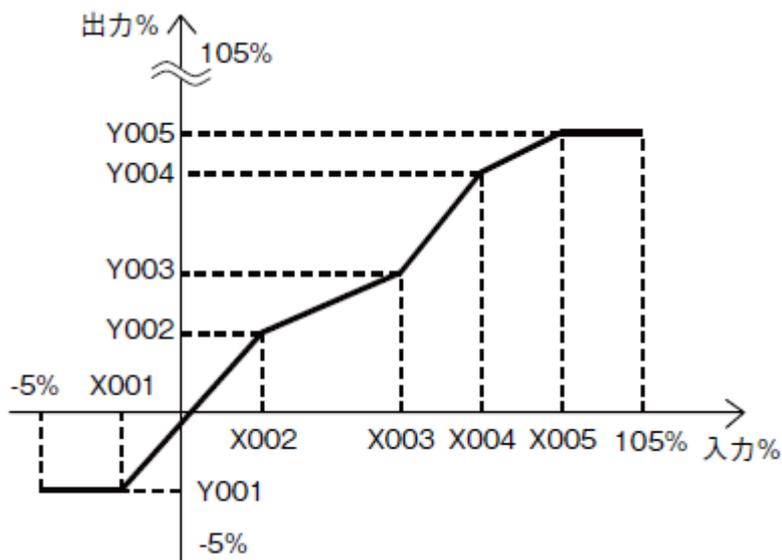
入力と等しい値が X で設定されていない場合は、設定されている X のうち、正負方向それぞれ最も近い値を一つずつ選択し、その 2 点を直線補完して Y を求め出力とします。
