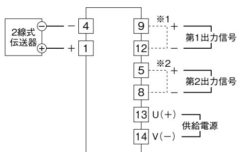
※1、第2出力の電圧を大きくとりたい場合は第1出力の端子間を短絡して下さい。ただし、スマートトランスマッタとの整合はお客様にてご確認下さい。
