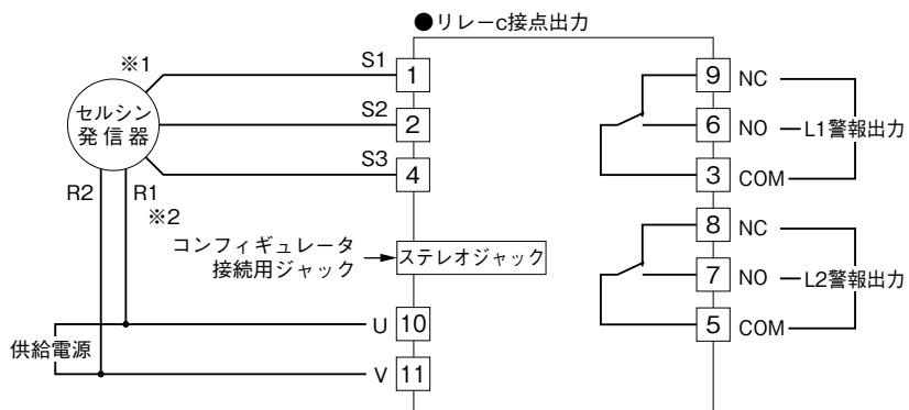
※1、出荷時はセルシン発信器が時計回転(CW)のとき入力実量値が増加します。
