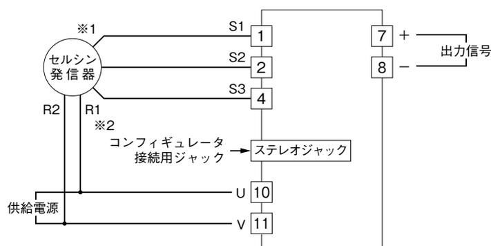
※1、出荷時はセルシン発信器が時計回転(CW)のとき出力増加となります。反時計回転(CCW)で出力を増加させるには、入力回転方向設定 (ITEM 10) をCCW (反時計回り) に設定して下さい。
