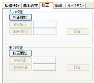
入力校正の校正開始ボタンをクリックすると、入力校正モードに入り、下図のように 0%校正ボタンと 100%校正ボタン、設定ボタンがクリックできるようになります。
