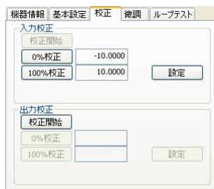
ここで、機器への入力を実際に 0%にしてから 0%のボタン、入力を実際に 100%にしてから 100%のボタンをクリックすると、そのときの入力に応じて、0%、100%の値が表示されます。たとえば、1V を入力して 0%校正、5V を入力して 100%校正をクリックすると下図のようになります。
