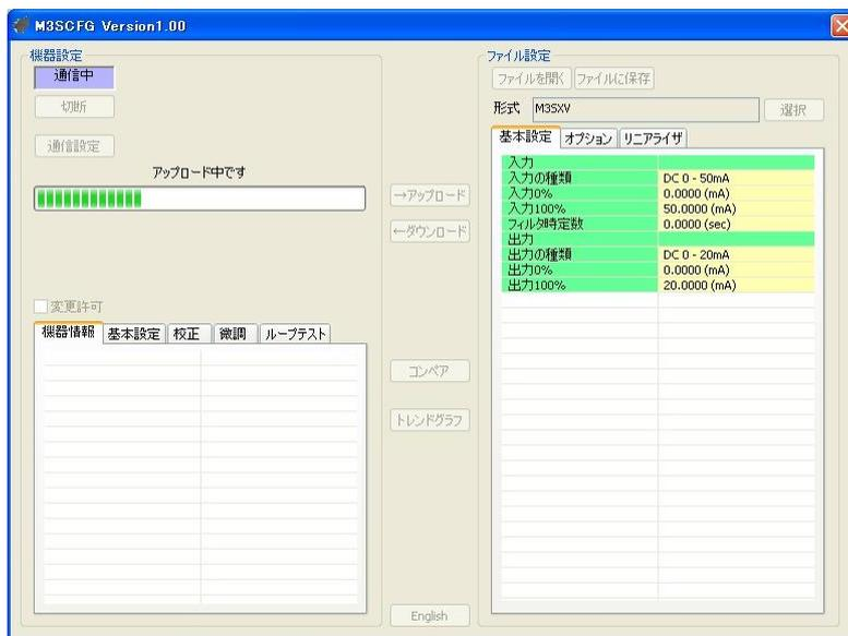
バーが右端まで進むとアップロードが完了し、読み込んだ内容が画面右のファイル設定に表示され、編集できるようになります。
