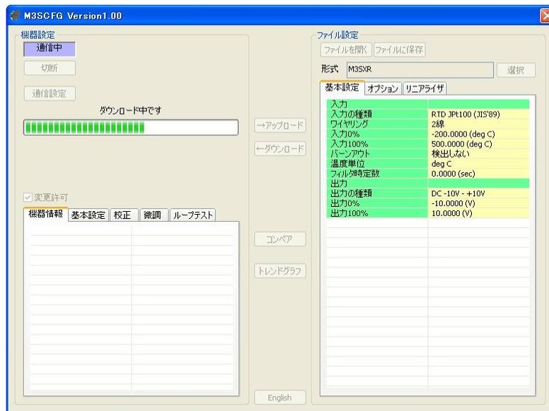
バーが右端まで進むとダウンロードが完了し、ファイル設定で編集中のパラメータが機器に書き込まれ、反映されます。
