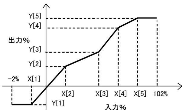
入力と等しい値が X で設定されていない場合は、設定されている X のうち、正負方向それぞれ、最も近い値を1つずつ選択し、その2点を直線補完して Y を求め、出力とします。
