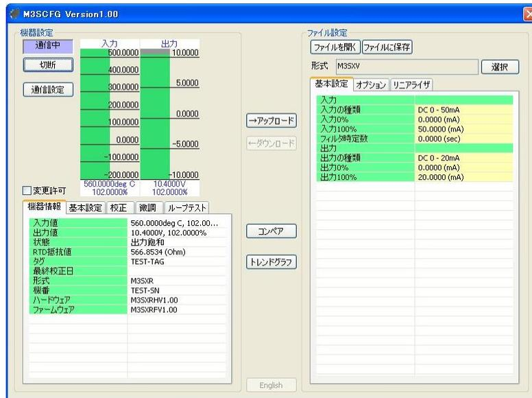
機器の入出力のレベルがバーグラフで表示され、その下にある「機器情報」「基本設定」「校正」「微調」「ループテスト」のタブで、機器への各種操作が行えます。
