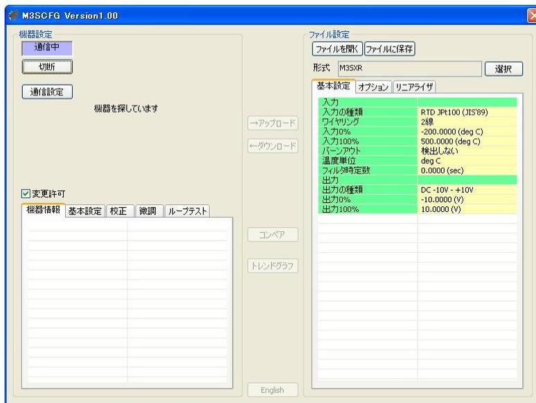
PC にコンフィギュレータ接続ケーブルを介して対応している機器を接続すると、自動的に形式が認識され下図のように機器の情報が表示されます。
