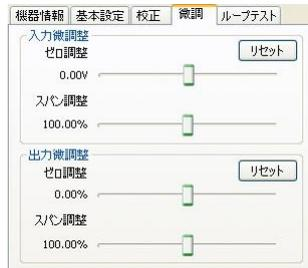
微調整は入出力ともにゼロ、スパンで行います。ゼロ調整がオフセット、スパン調整がゲインの調整となります。
