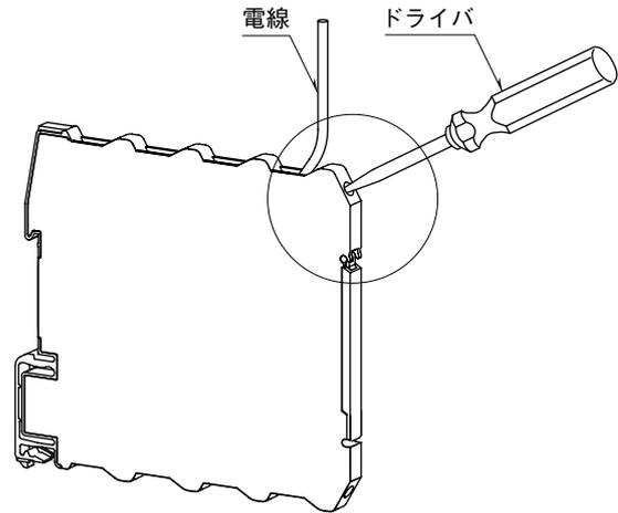
電線の先が奥に当たるまで挿入し、ドライバでねじを締めて下さい (ねじ締付トルク: 0.3 N·m)。被覆部を端子に挟まないように注意して下さい。
