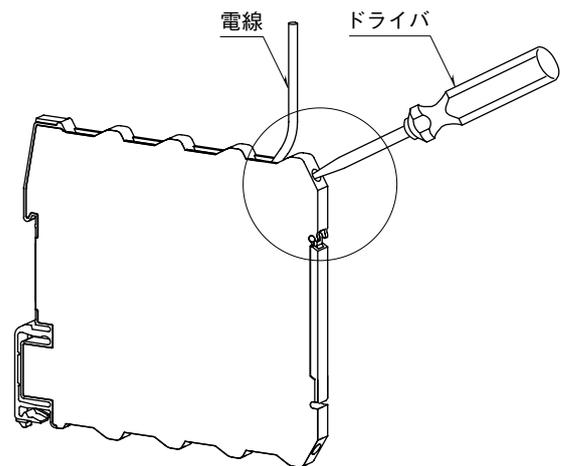
電線の先が奥に当たるまで挿入し、ドライバでねじを締めて下さい (ねじ締付トルク : 0.3 N・m)。
