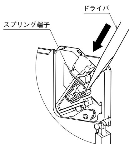
② ドライバの先端の刃厚が薄く、電線の挿入口の開きが不十分な場合は、ドライバを矢印の方向に傾けて電線を挿入して下さい。
