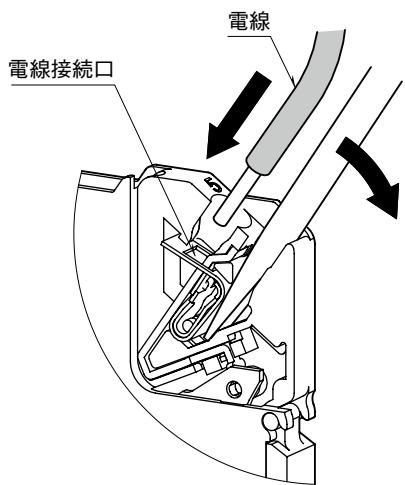
③ 電線の先が挿入口の奥に当たるまで挿入し、電線を押さえたままドライバを引抜きます。
