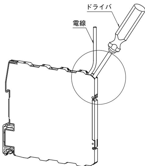
① ドライバの先端をスプリング端子とケースの間に奥まで差込みます。奥まで差込むとドライバは固定されます。
