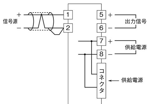
注) 本器は超高速形のため原理的に入力信号に含まれるノイズだけを変換器内で減衰させることはできません。したがってシールド付より対線を使用するなど入力信号にノイズが混入しないように十分ご注意ください。
