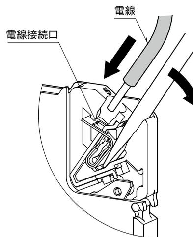
③ 電線の先が挿入口の奥に当たるまで挿入し、電線を押さえたままドライバを引抜きます。被覆部を端子に挟まないように注意して下さい。
