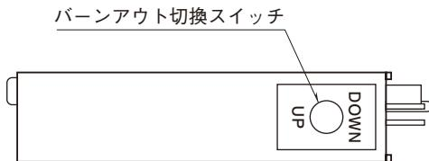
下面スイッチをバーンアウト上方の場合は UP に、バーンアウト下方の場合は DOWN に回して下さい。
