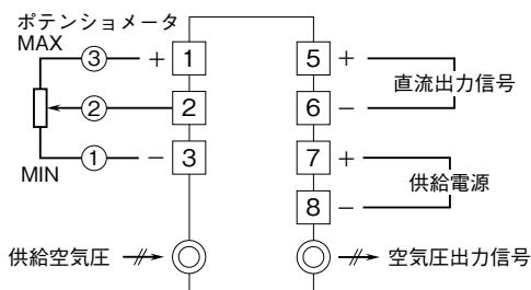
注) 電流出力の場合は必ず負荷を接続して下さい (負荷を接続しないときは、出力端子⑤ー⑥間を短絡して下さい)。
