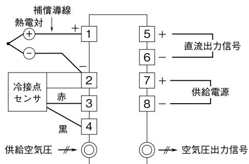
注) 電流出力の場合は必ず負荷を接続して下さい (負荷を接続しないときは、出力端子⑤-⑥間を短絡して下さい)。
