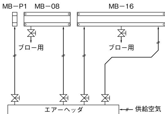
使用される配管のサイズは、必要な流量に応じて選定して下さい。また、保守点検が容易になるよう、エアーヘッダからマウントブロックとの配管の途中にコックを設置して下さい。
