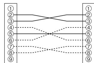
実線と破線による接続はインターリンクケーブル使用例です。
