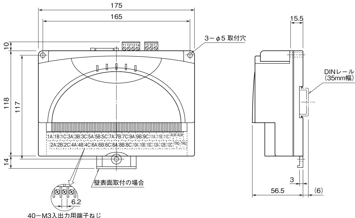
注) 水平でなく垂直のDINレールに取付ける場合、重力による滑り落ち防止のために、オムロン製 エンドプレート（形式：PFP-M）、IDEA製 止め金具（形式：BNL6）などの固定金具のご使用をおすすめします。
