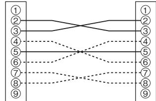
実線と破線による接続はインターリングケーブル使用例です。
