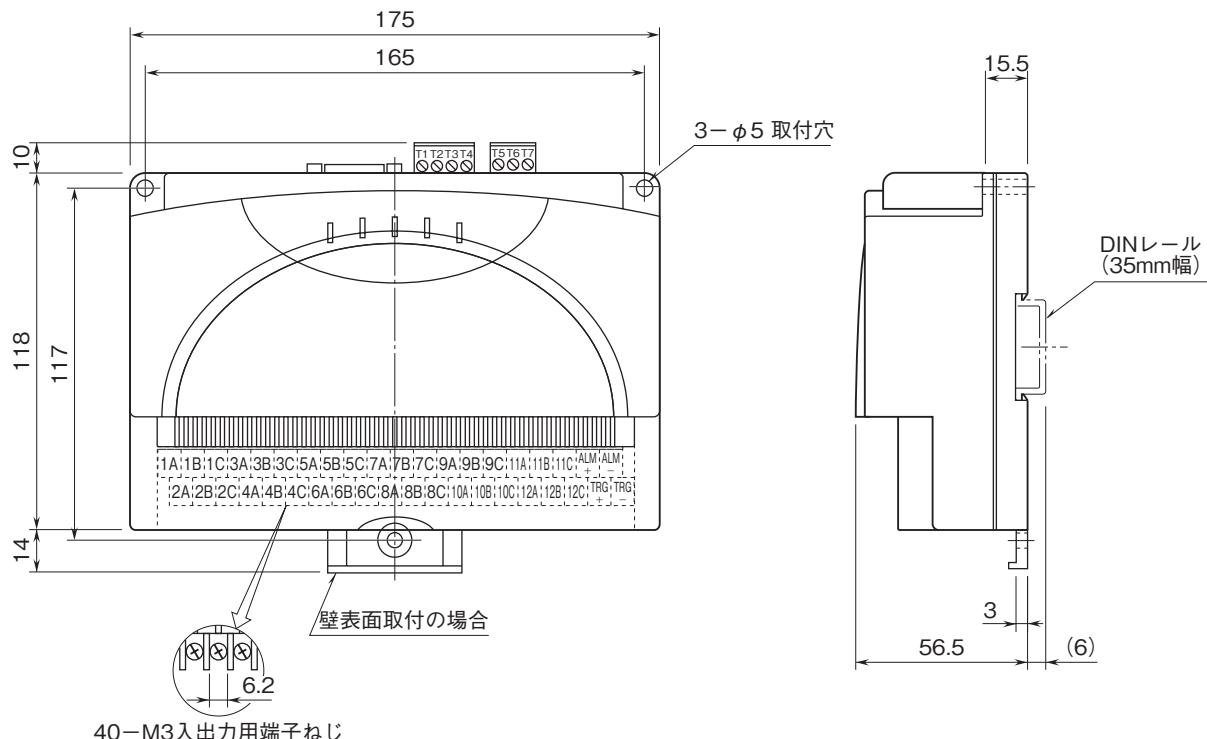
注) 水平でなく垂直のDINレールに取付ける場合、重力による滑り落ち防止のために、オムロン製 エンドプレート（形式：PFP-M）、IDEC製 止め金具（形式：BNL6）などの固定金具のご使用をおすすめします。
