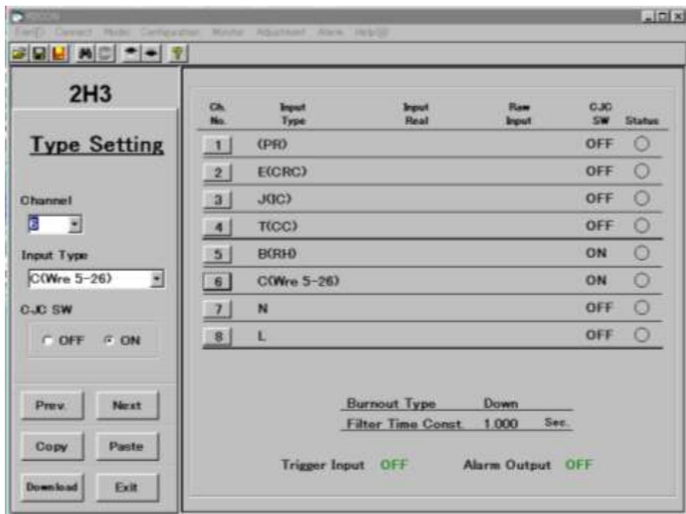
設定内容をコピーするために、[Copy]ボタンをクリックします。次に [Next]ボタンをクリックし、チャネル番号 7 のパラメータ設定画面になったことを確認し、[Paste]ボタンをクリックします。以下のような画面になります。
