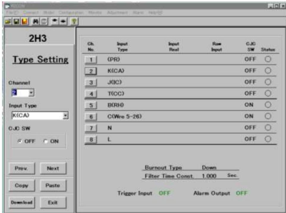
Input Type のコンボボックスで、<E(CRC)> を選択します。
