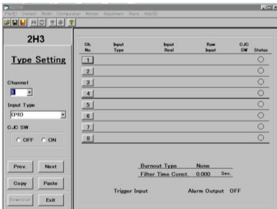
Input Type のコンボボックスで、E(CRC)を選択し、CJC SW のオプションボタンを ON にします。
