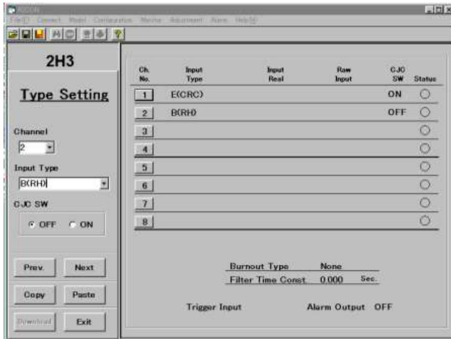
右側のウィンドウのチャネル番号 2 の Input Type が B(RH)、CJC SW が OFF に設定されたことを確認してください。
