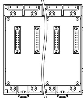
R3-BS 使用時は、入出力カードは、I/O 1 から順に隙間なく実装して下さい。I/O 1 が未実装、またはスロットを飛ばして入出力カードを実装すると、エラーとなり、通信できません。
