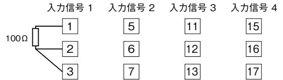
未使用の入力端子に抵抗器が接続されていない場合、ERR表示ランプが赤色に点灯し、PLC等にバーアウトフラグがセットされます。コンフィギュレータソフトウェア (形式：R3CON) を用いることにより、未使用入力の処理を行わずに、未使用入力の設定が可能です。
