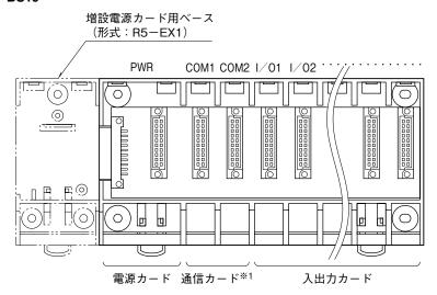
※1、2重化用の入出力カードを使用しない場合は、通信カードはCOM1に実装して下さい。
