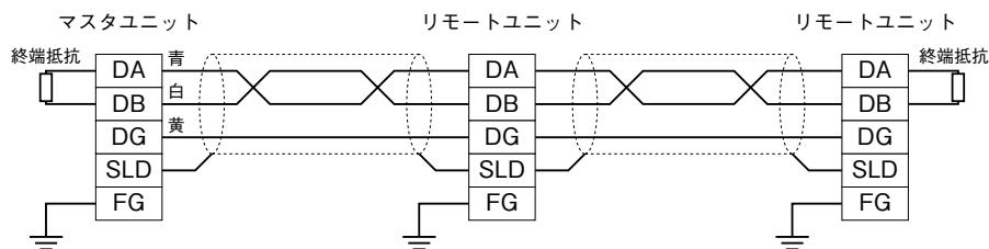
両端のユニットには、必ず同梱の“終端抵抗”を接続して下さい。
