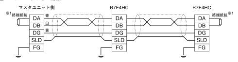
※1、内蔵の終端抵抗を使用する場合は終端抵抗設定用スイッチをONにして下さい。
