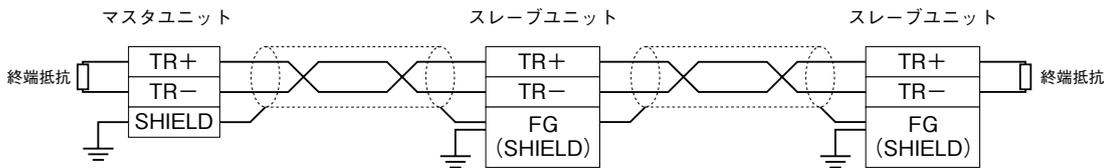
注) 両端のユニットには、必ず終端抵抗設定用スイッチをONにして下さい。
