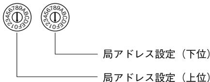
\* 1、R7ML はインテリジェント I/O タイプのため、局アドレスは 60H ~ 7FH に設定して下さい。マスタユニットにより、設定できない局アドレスがあります。マスタユニットの取扱説明書にてご確認下さい。
