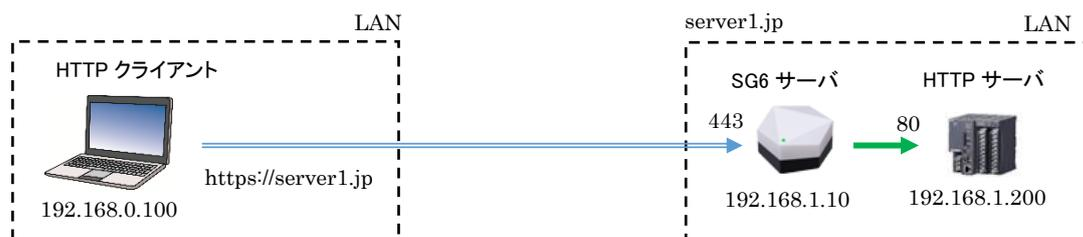
標準モードの SG6 サーバのみを使用したときの SG6 の「App Configuration」の設定例は以下となります。その他の設定項目は必要に応じて設定してください。
