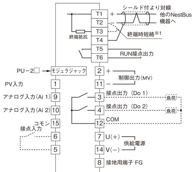
※1、より対線の伝送ラインが終端の場合は(=渡り配線がない場合)、端子 T2、T3間を付属のショートチップ(または配線)で短絡して下さい。
