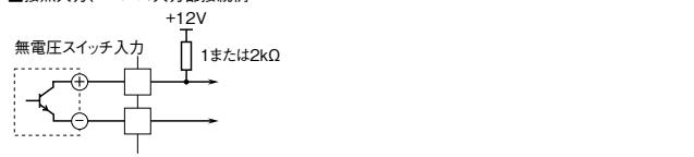
※3、電流入力時は抵抗モジュール（形式：REM4）を取り付けて使用します。
