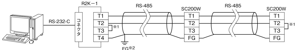
※1、回路の終端となる場合に、内部の終端抵抗を使用します。
