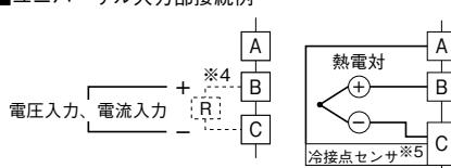
※4、電流入力時は抵抗モジュール（形式：REM4）を取付けて使用します。
