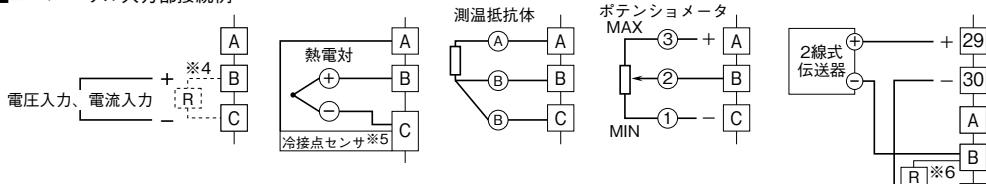
※4、電流入力時は抵抗モジュール（形式：REM4）を取付けて使用します。
