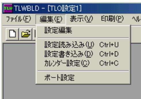
パソコン上の TLO ビルダと TLO の間の通信に関する設定と、通信を実行するためのメニューです。TLO からパソコンへのデータの読み出し操作（アップロード）、パソコンから TLO への設定データ書き込み操作（ダウンロード）を行う場合は、TLO のモードスイッチを必ず“MAINT”の位置にしてください。“MON”の位置で読み出し、書き込み操作を行うとエラーになります。
