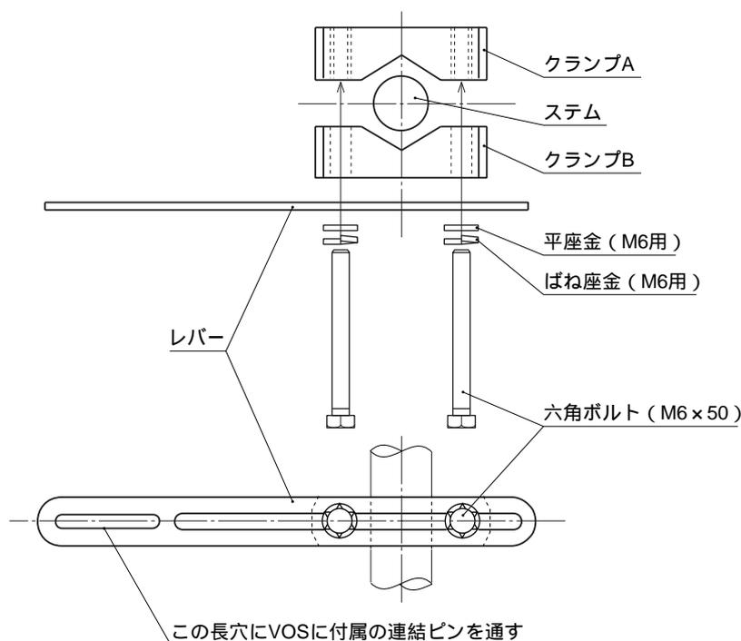
図1 クランプセットの取付方法
