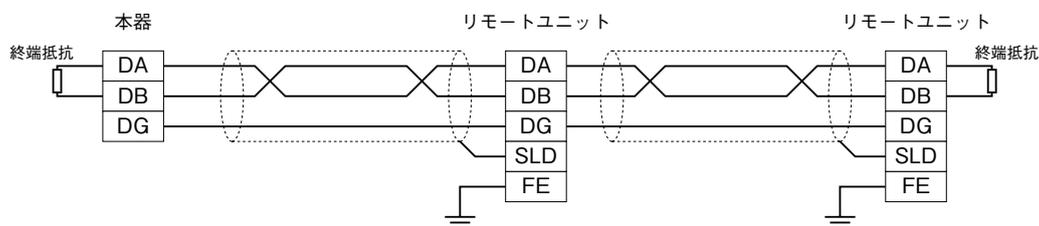
注) 両側のユニットには、必ず“DA”“DB”間に“終端抵抗”を接続して下さい。
