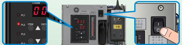
[○] 側を押して、信号発生器の前面にある [PL2] のLED点灯を確認します。
