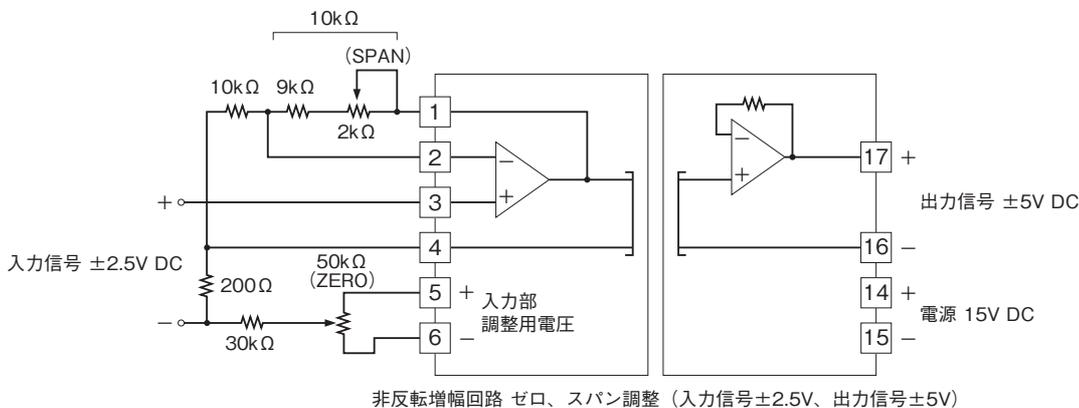
■反転増幅外部調整回路：反転増幅回路のゼロ、スパン調整回路例  $G=-1$ （入力に対して出力は反転します。）
