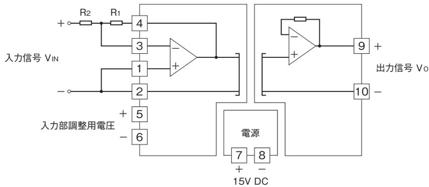
反転増幅回路  $G = -R_1/R_2$
