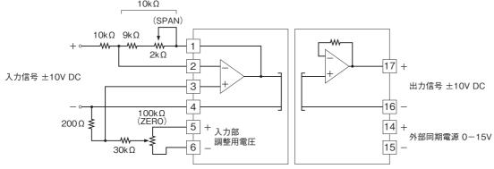
反転増幅回路 ゼロ、スパン調整(入力信号±10V、出力信号±10V)
