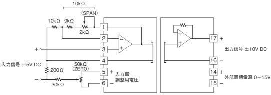
非反転増幅回路 ゼロ、スパン調整 (入力信号±5V、出力信号±10V)
