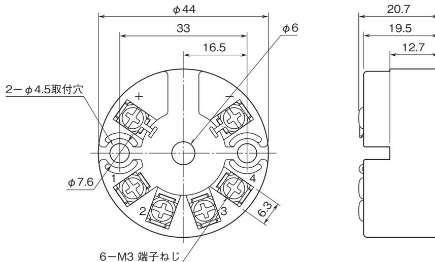
取付寸法図(単位:mm)
