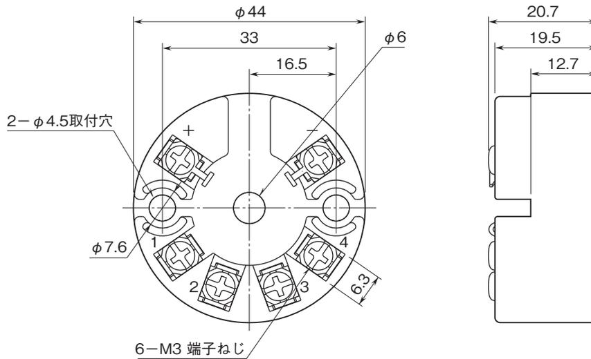
取付寸法図(単位:mm)
