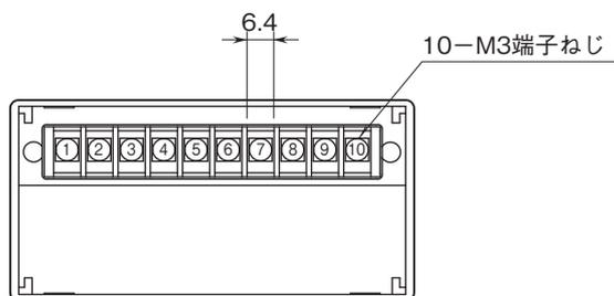
取付寸法図(単位:mm)
