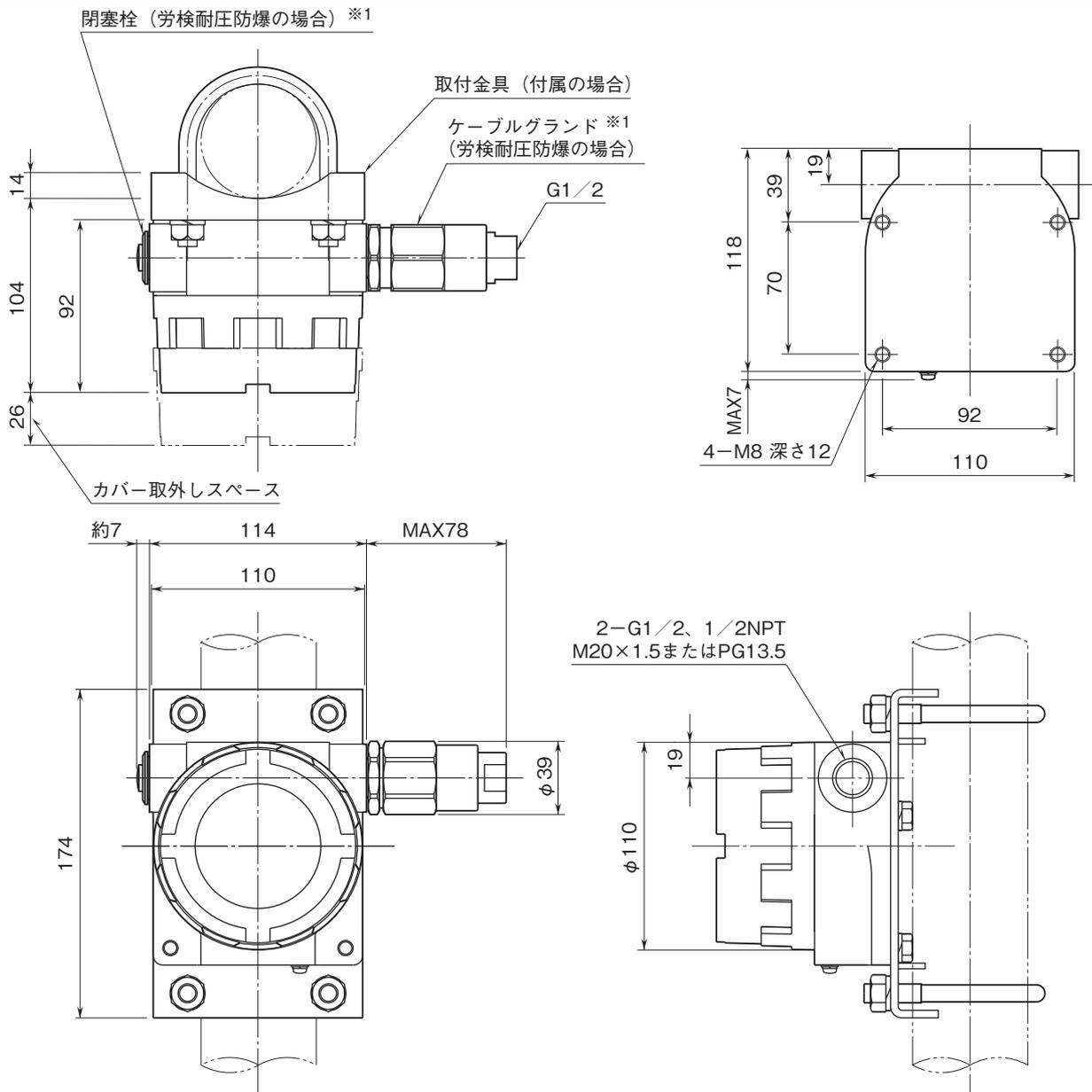
※1、労検耐圧防爆の場合、ケーブルグラウンド2個と閉塞栓1個が付属しています。
