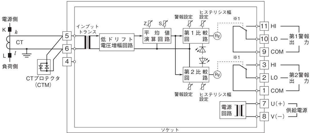
※1、警報出力コード“1、4”のときの電源OFF時の接点状態です。
