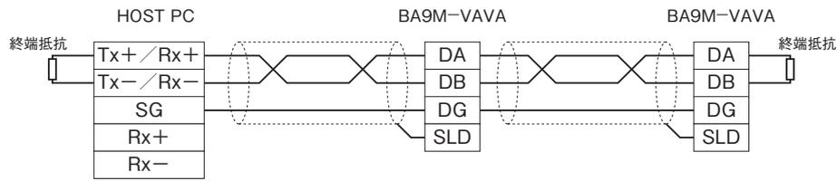
両端のユニットには、必ず同梱の“終端抵抗”を接続して下さい。
