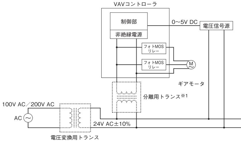
※1、電圧信号源が未絶縁電源で構成されている場合、絶縁トランスを外付けして下さい。
