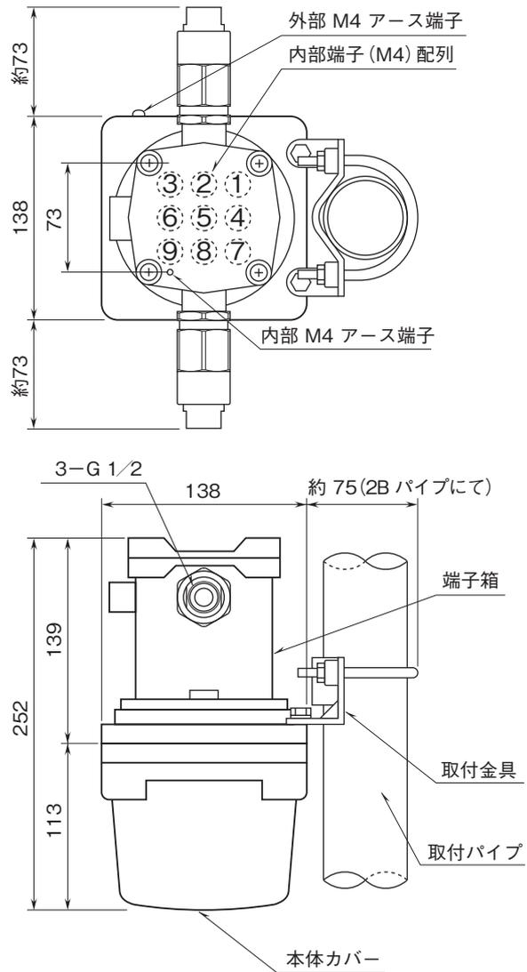
取付寸法図(単位:mm)
