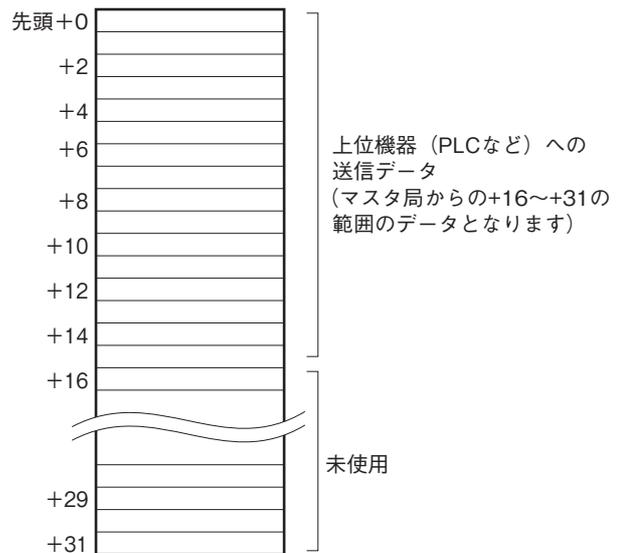
注) 上位機器（PLC など）同士の通信を行う場合、相手局からのデータは上位アドレスに入力され、相手局への送信データは下位アドレスに出力する必要があります。
