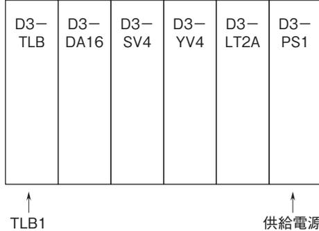
バックアップ電池接続カード（形式：D3-TLB）は必ず左端に実装して下さい。
