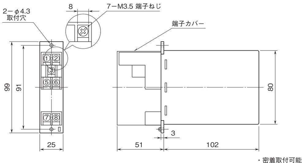
取付寸法図(単位:mm)
