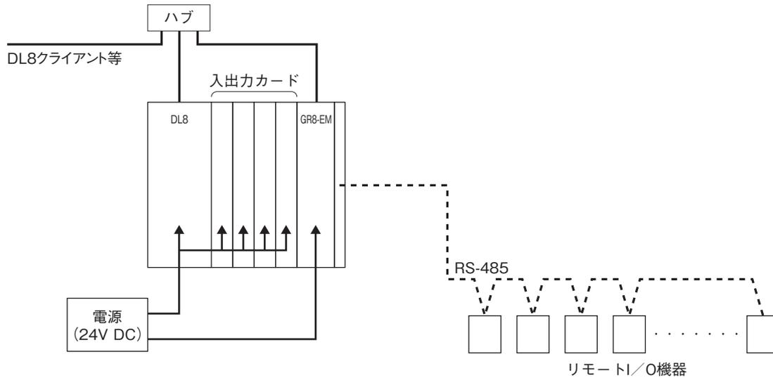
注) DL8を経由しての電源供給は行えません。供給電源用のコネクタから電源を供給して下さい。
