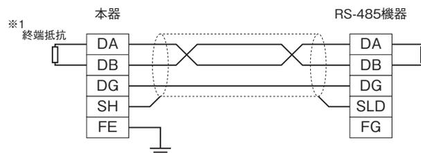
※1 内蔵の終端抵抗を使用する場合、終端抵抗設定用スイッチをONにして下さい。
