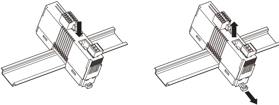
注) 水平でなく垂直に DIN レールへ取付ける場合は、重力による滑り落ち防止のため、オムロン製エンドプレート (形式: PFP-M)、IDEC 製止め金具 (形式: BNL6) などの固定金具のご使用をおすすめします。
